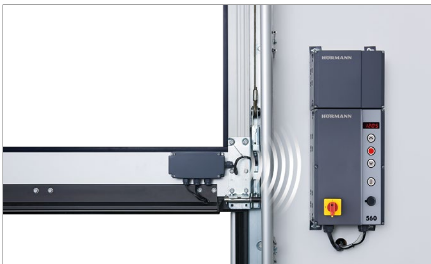
Unidad de comunicación vía radiofrecuencia Para transmitir las señales de la hoja mediante Bluetooth al cuadro de maniobra (sin cable espiral), fuente de alimentación a través de una batería potente; componentes conectables: sensores ópticos LE ("low energy"), célula fotoeléctrica antepuesta VL1-LE / VL2-LE, listón 8k2, interruptor de cable flojo, contacto de puerta peatonal incorporada, contacto para cierre nocturno
