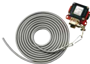
Interruptor de tracción con cable de tracción de material sintético Montaje posible en horizontal o vertical, carcasa de aluminio fundido a presión, IP 65, largo de cable de 4 m
