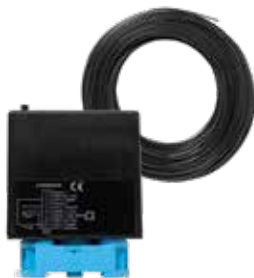
Lazo de inducción Detector de lazo de inducción con cierrapuertas y convertidor, ajustable al contacto permanente o por impulsos, con detección de dirección, cable para lazo de 50 m
