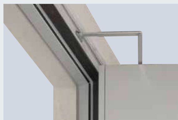
Cerco de bloque 140 / 75 mm, de 3 piezas con ranura de obturación perimetral de 3 lados
