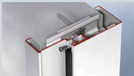
Atornillar el perfil 2 del contracerco a través de la ranura de la junta con el perfil 1, y cubrir con la junta de la puerta
